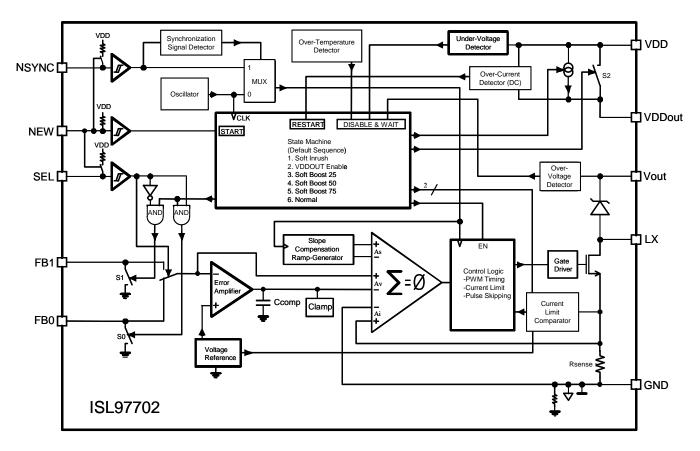
FIGURE 1. ISL97702 BLOCK DIAGRAM
