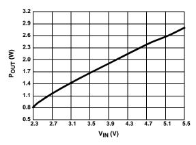
FIGURE 15. RECOMMENDED MAXIMUM OUTPUT POWER vs INPUT VOLTAGE
