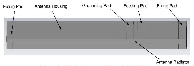
FIGURE 1. CELLULAR 790-2700MHZ CERAMIC ANTENNA
