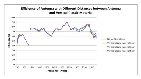
FIGURE 4.3.2 EFFICIENCY COMPARISON AT 790-960MHZ AND 1.7-2.7GHZ BAND OF DIFFERENT VERTICAL PLASTIC COVER DISTANCE FROM ANTENNA
