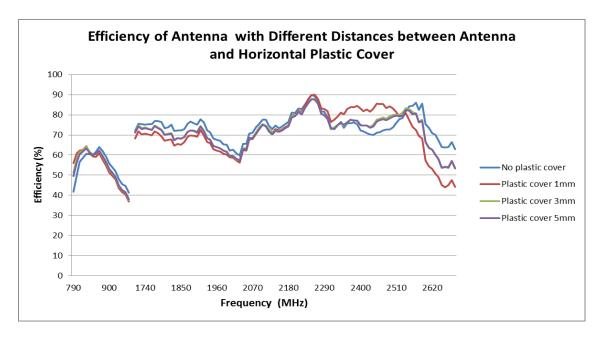
FIGURE 4.4.2 EFFICIENCY COMPARISON AT 790-960MHZ AND 1.7-2.7GHZ BAND OF DIFFERENT HORIZONTAL PLASTIC COVER DISTANCE FROM ANTENNA
