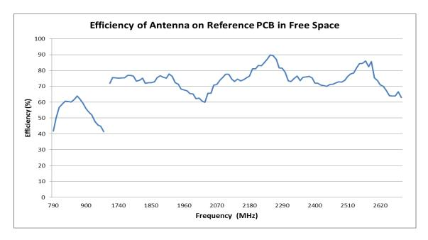
FIGURE 2.3 EFFICIENCY OF ANTENNA AT 790-960MHZ AND 1.7-2.7GHZ BAND AT REFERENCE LOCATION IN FREE SPACE
