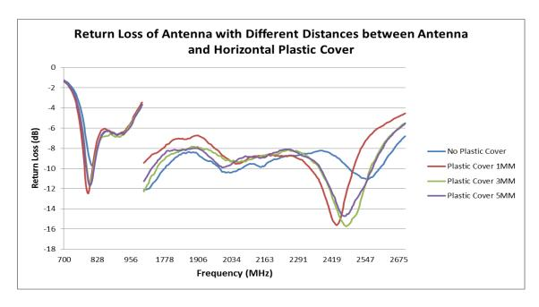
FIGURE 4.4.1 RETURN LOSS COMPARISON AT 790-960MHZ AND 1.7-2.7GHZ BAND OF DIFFERENT HORIZONTAL PLASTIC COVER DISTANCE FROM ANTENNA
