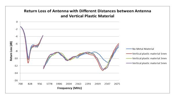
FIGURE 4.3.1 RETURN LOSS COMPARISON AT 790-960MHZ AND 1.7-2.7GHZ BAND OF DIFFERENT VERTICAL PLASTIC COVER DISTANCE FROM ANTENNA
