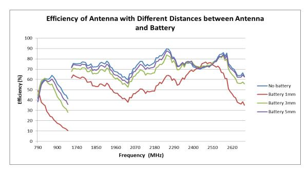
FIGURE 4.2.2 EFFICIENCY COMPARISON AT 790-960MHZ AND 1.7-2.7GHZ BAND OF DIFFERENT BATTERY DISTANCE FROM ANTENNA
